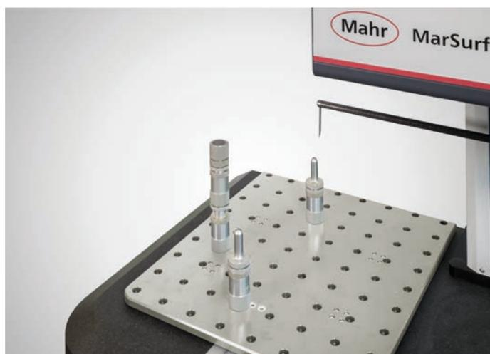
Piastra di alloggiamento con "set di appoggi a vite" inclusi appoggi a punta e supporto magnetico
