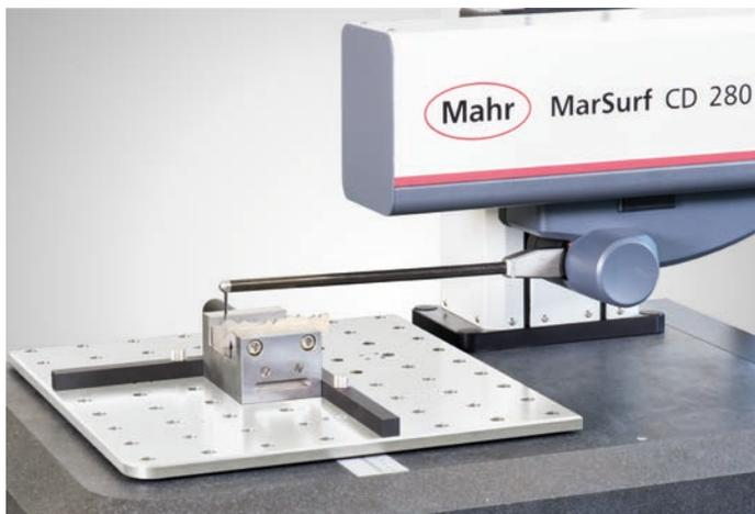
Misura con tastatore standard CPG A 36-350-25/12° sul campione di taratura
