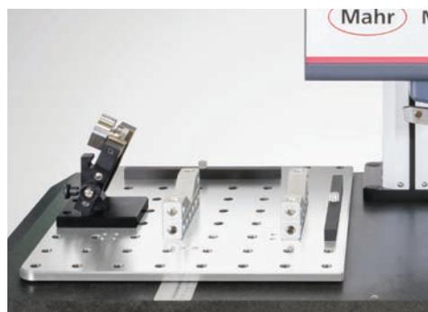
Dispositivo di serraggio flessibile e blocchi prismatici
