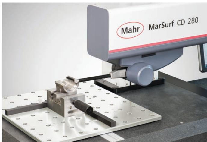
Misura con tastatore trasversale CPG A 33-210-25/30 q50
